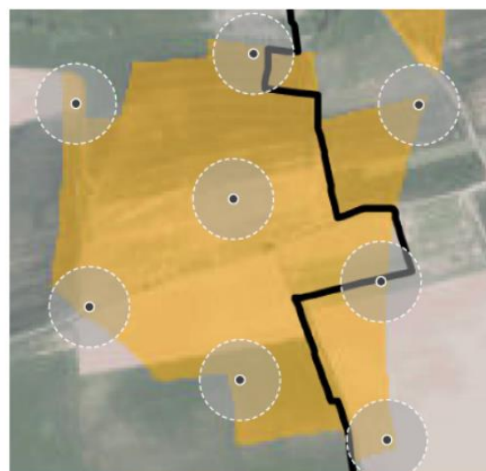
Abbildung 5: Beispielhafte Darstellung der Rotor-in- und Rotor-out-Regelung (Quelle: eigene Darstellung 03/2023)
