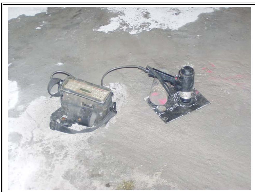
Foto 6: PID- Messungen im abgedichteten Bohrloch
