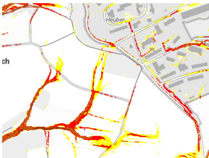
Abb. 11: Ausschnitt der Sturzflutkarte RLP (Darstellung von Fließwegen bei einem außergewöhnlichen Starkregen) mit Hervorhebung des Plangebietes (blaue Linie)
