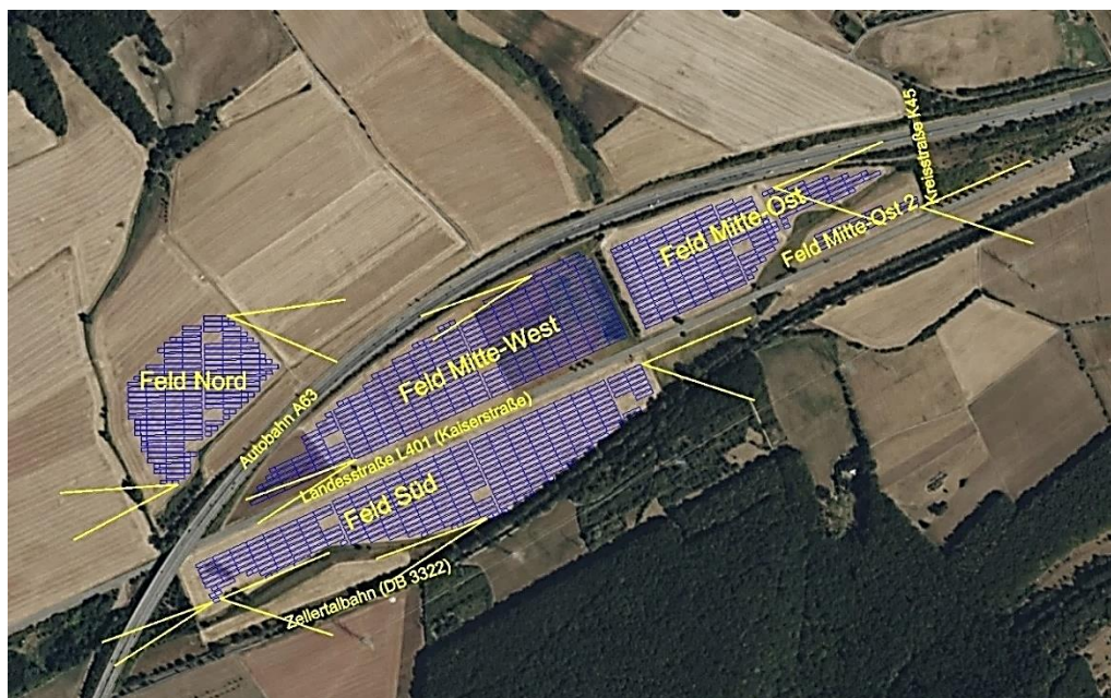
Abbildung 9: Mögliche Blendrichtungen (gelb), angezeichnet an ausgewählte Eckpunkte der PV-Anlage
