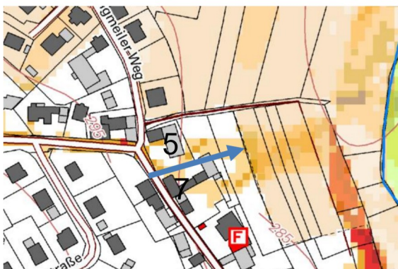
Abbildung 12: Fließweg Hauptstraße zwischen Gebäuden 5 und 7
