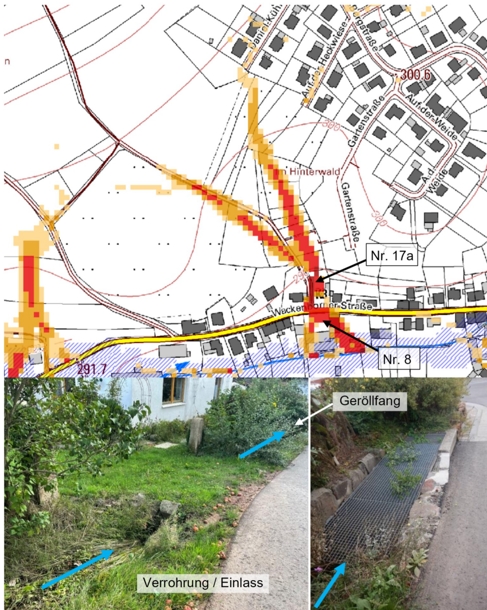
Abbildung 35: Wackenborner Straße, gefährdete Gebäude. Fließwege blau
