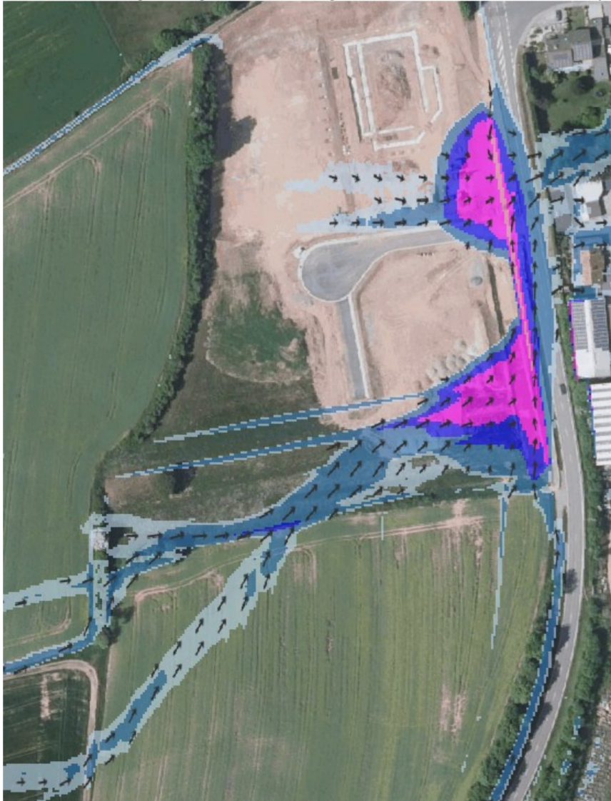
Abbildung 42: Fließrichtungen und Wassertiefen während der Bauphase
