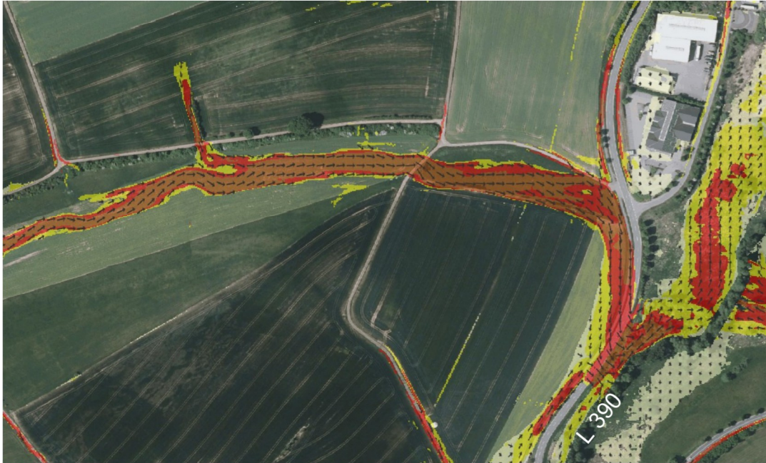
Abbildung 44: Kritischer Bereich L 390 (Fließgeschwindigkeiten und Fließwege)
