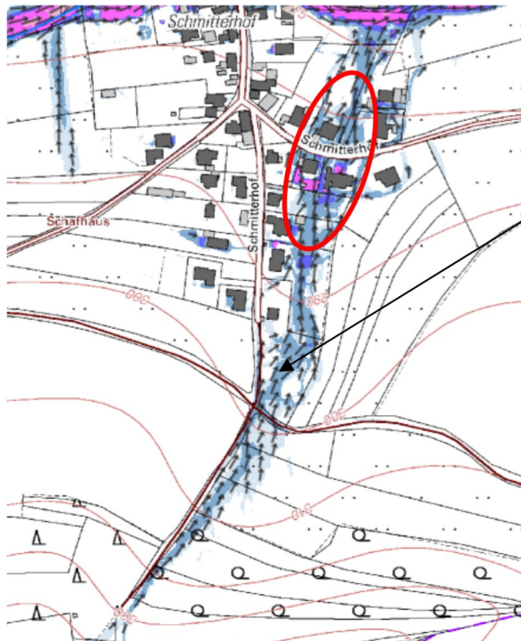
Abbildung 33: Wasserstände und Fließrichtung SRI 7
