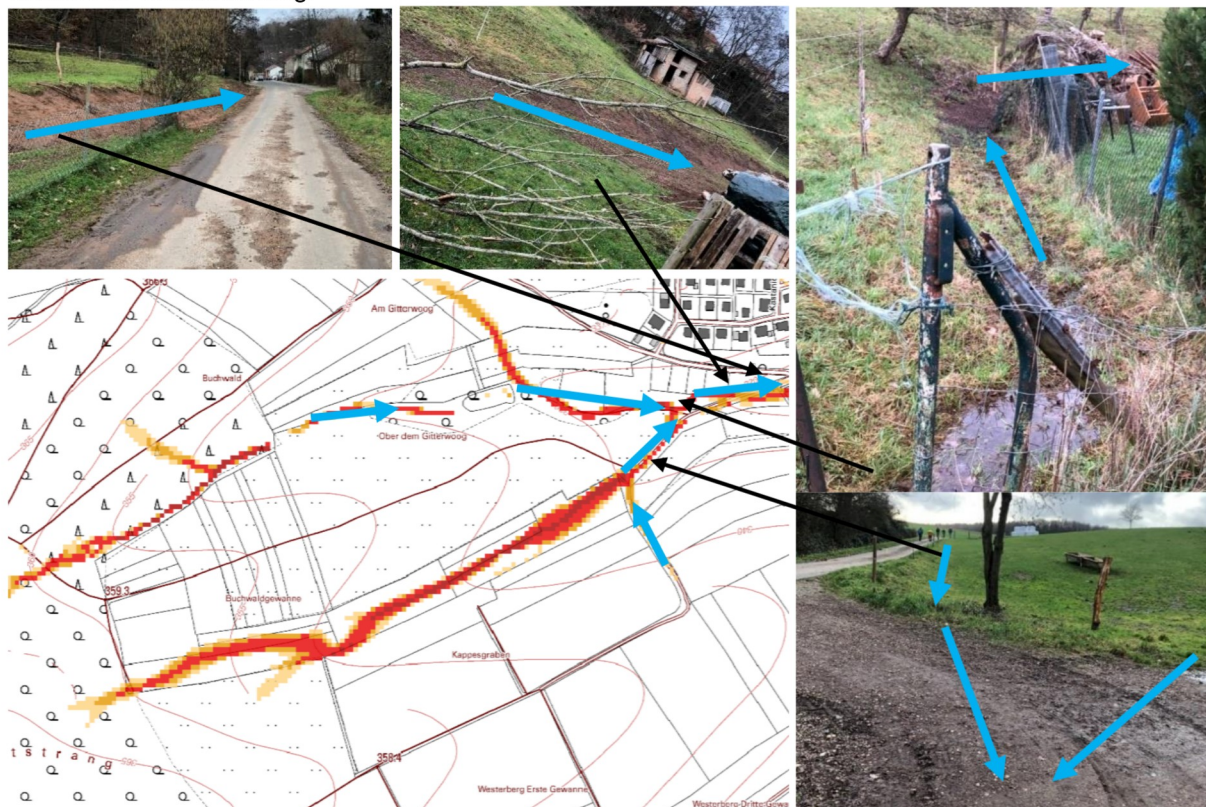
Abbildung 23: Am Schimmelberg, Fließwege (blau) im Außengebiet
