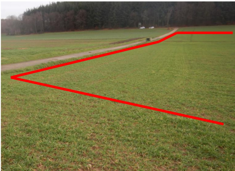
Abbildung 34: Maßnahmenvorschlag: Rückhalteraum (rot) durch Anpassung der Wirtschaftswege
