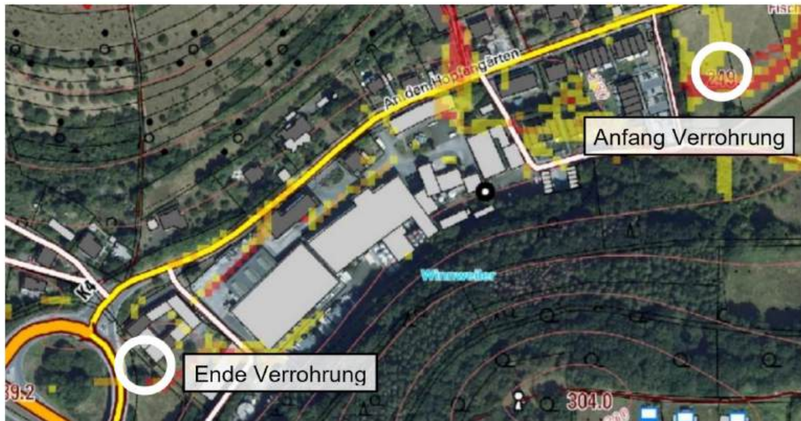
Abbildung 19: Verrohrung unterhalb der Bebauung bzw. des Brauereigeländes
