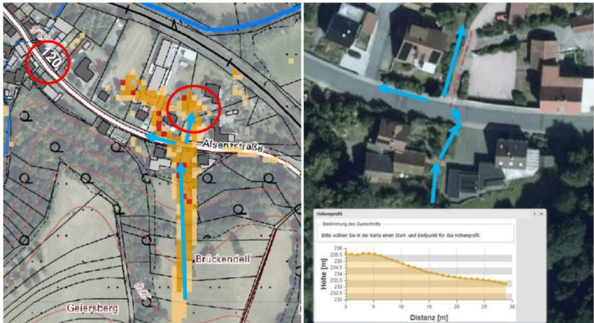
Abbildung 111: Brückendell, Fließwege (blau), potenziell überflutungsgefährdeter Bereich (rot)
