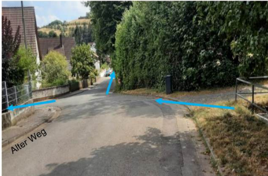
Abbildung 94: Fließwege bei Überlastung der Verrohrung
