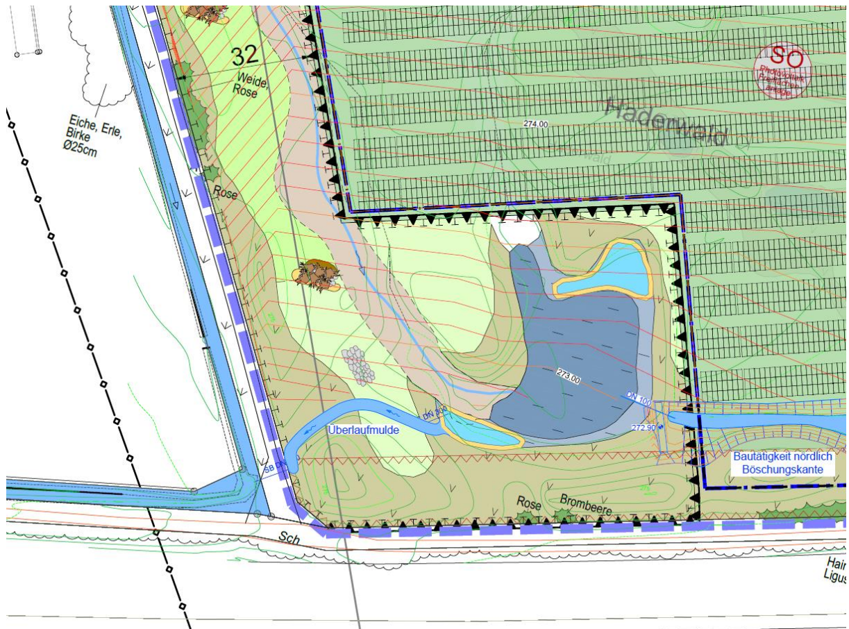
Abbildung 4 Detailansicht Überlaufmulde im Südwesten des Plangebietes (Eigene Darstellung WVE GmbH KL, 2024)
