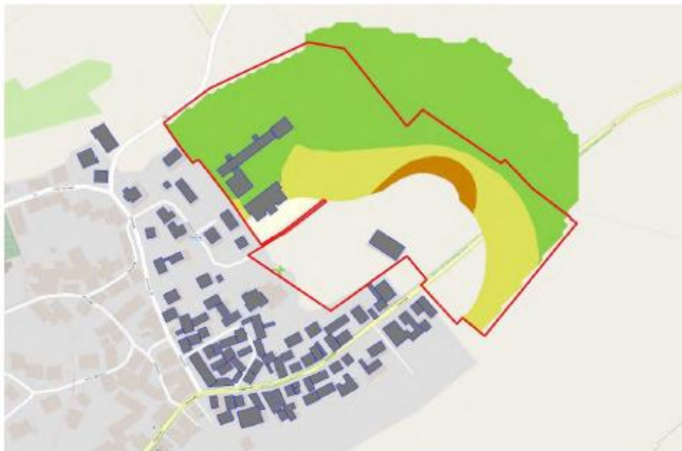
Abbildung 35. Darstellung der nach der Überlagerung der Ergebnisse der Ausbreitungsrechnungen für Schall und Geruch für Wohngebiete (WA, grün) und Dorfgebiete (MD, gelb) zulässigen Flächen, Bebauungsplangebiet in Rot markiert, Istzustand, kein Wall.
