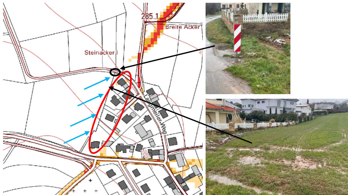
Abbildung 48: Langmeiler Weg, gefährdeter Bereich rot, Einlass schwarz und Fließwege in blau
