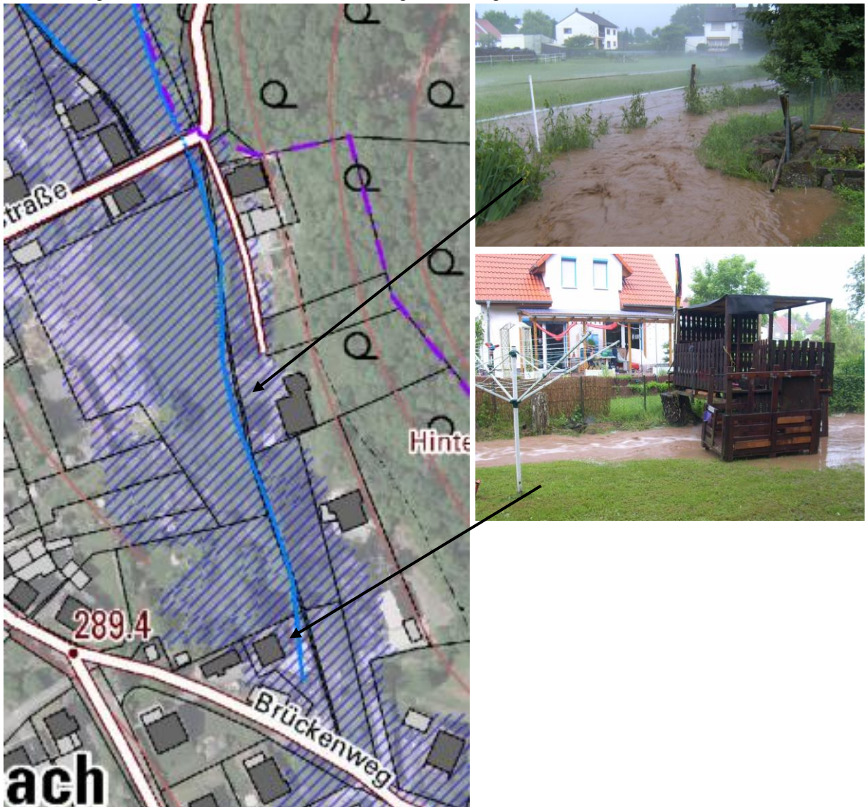
Abbildung 41: überflutungsgefährdete Bereiche Gonbach (blau schraffiert)
