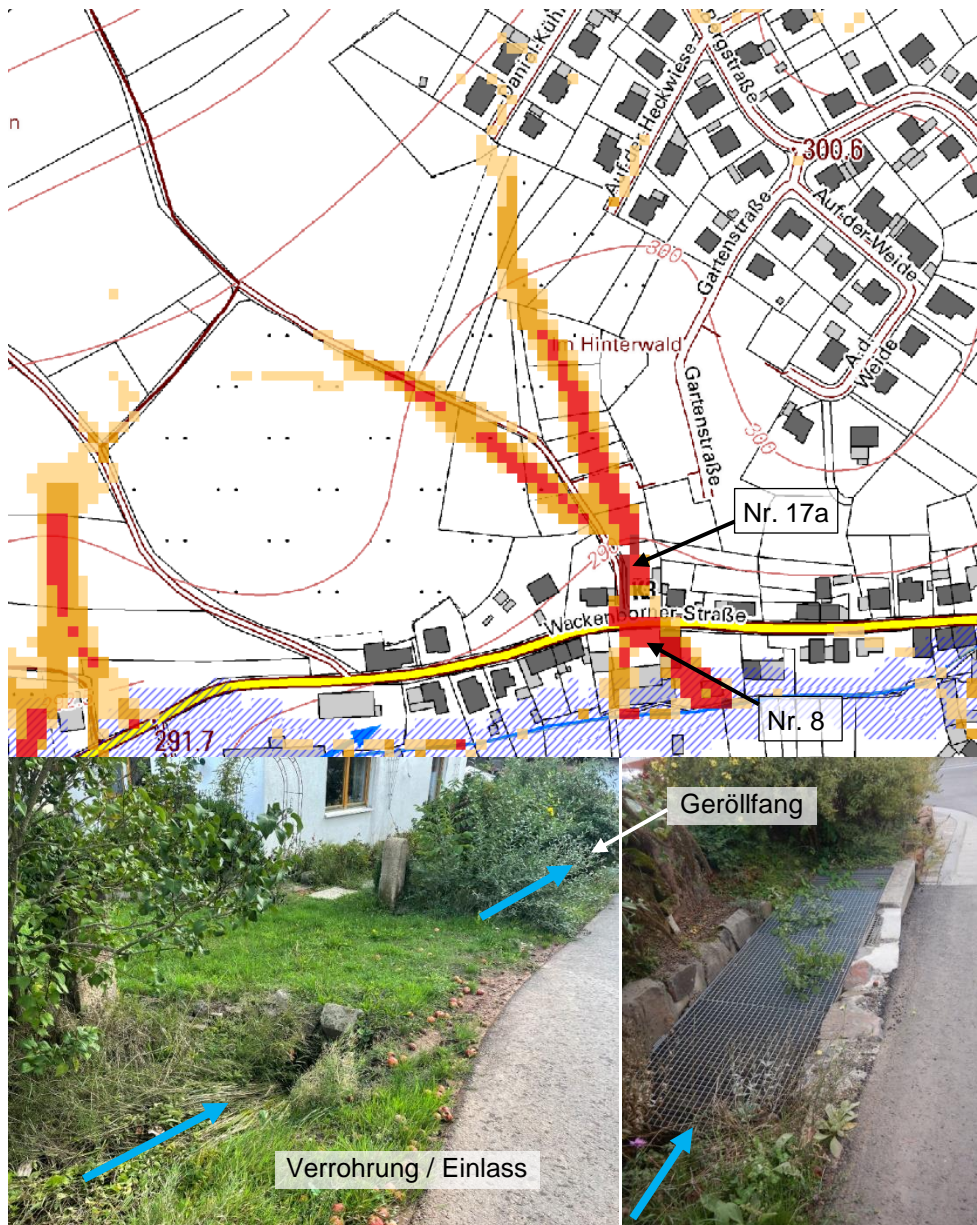
Abbildung 35: Wackenborner Straße, gefährdete Gebäude. Fließwege blau
