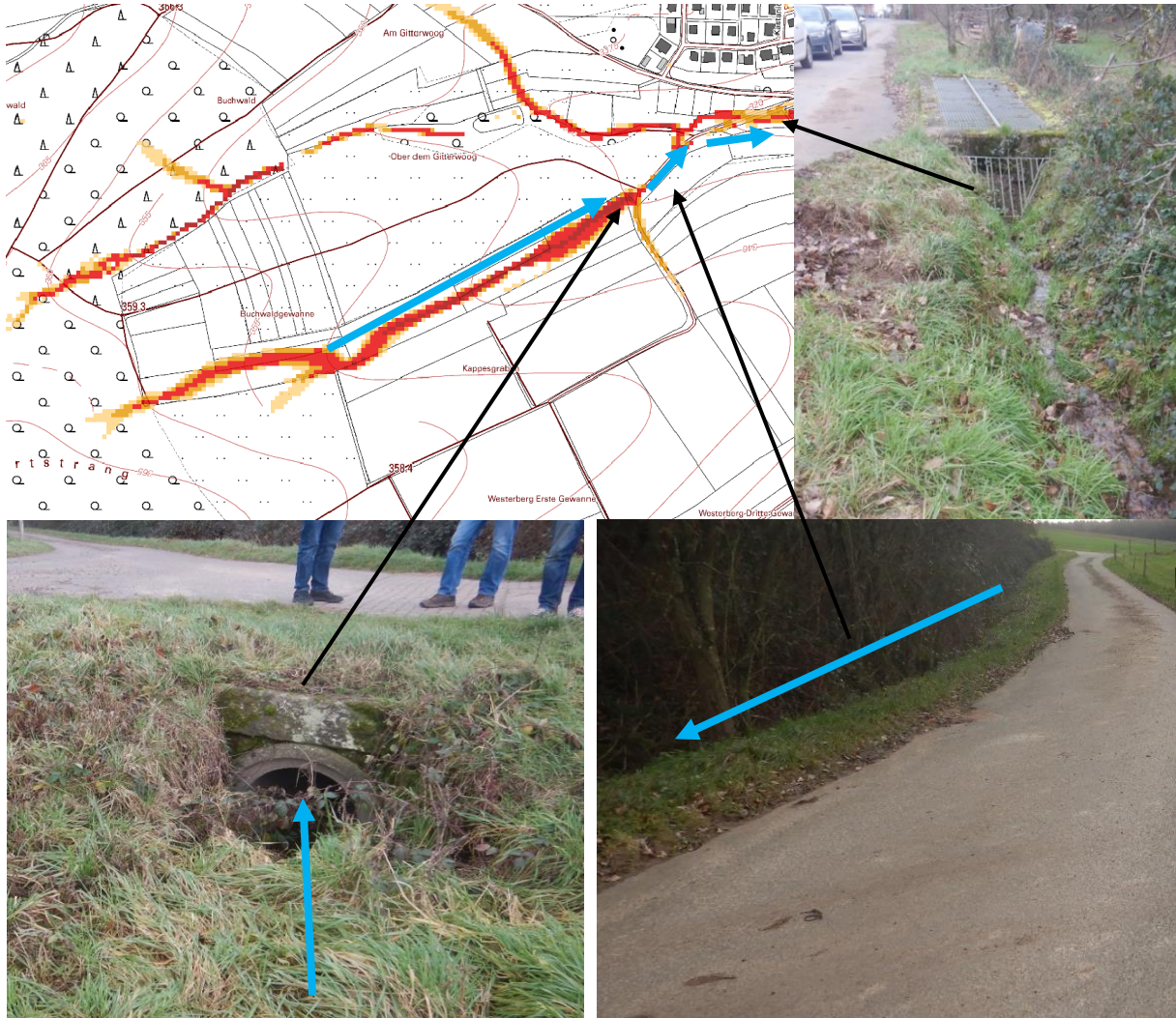
Abbildung 22: Am Schimmelberg, Entwässerungssystem am Rand der Ortslage
