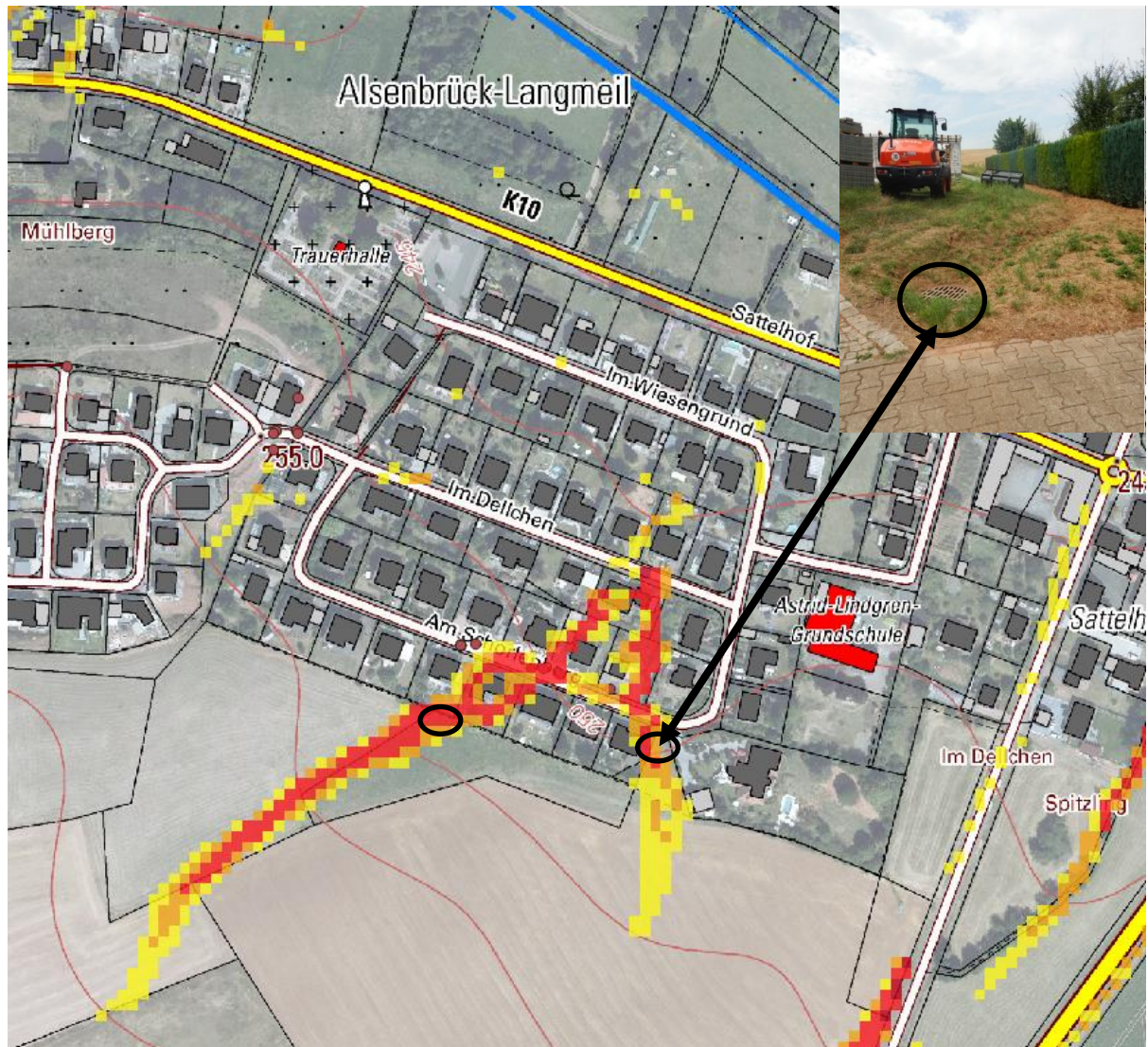
Abbildung 118: Am Schorlenberg, Starkregenfließlinien und Einlassbauwerke (schwarz)
