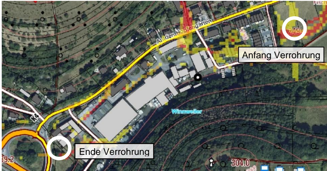
Abbildung 19: Verrohrung unterhalb der Bebauung bzw. des Brauereigeländes
