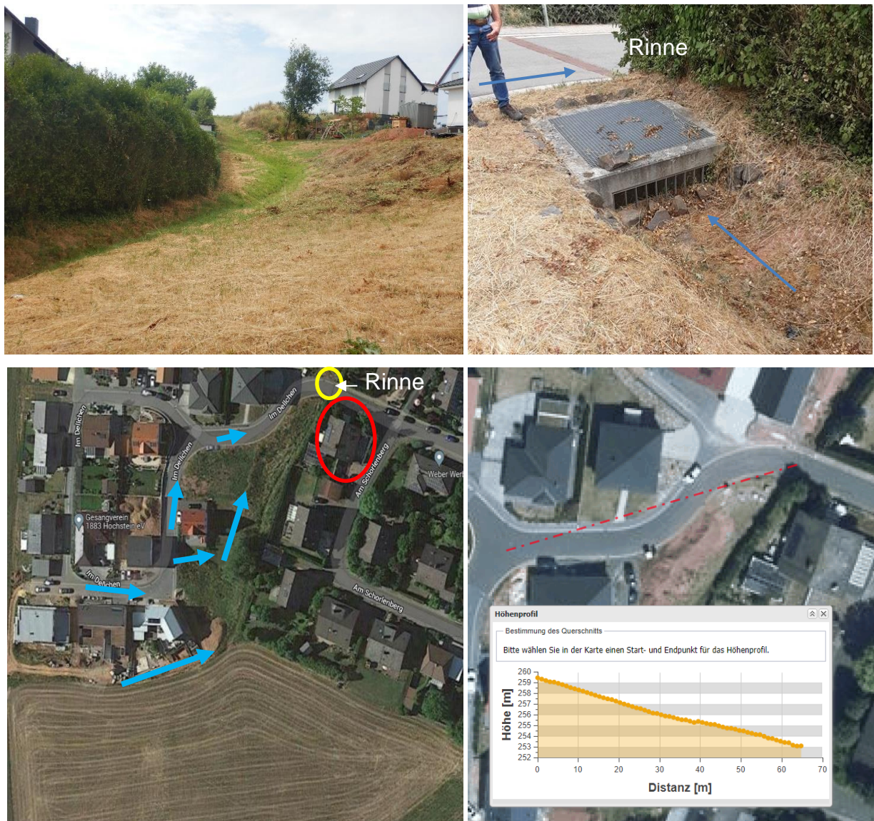
Abbildung 124: Entwässerungssituation "Im Dellchen", Fließwege (blau), Rinne (gelb), gefährdeter Bereich (rot)
