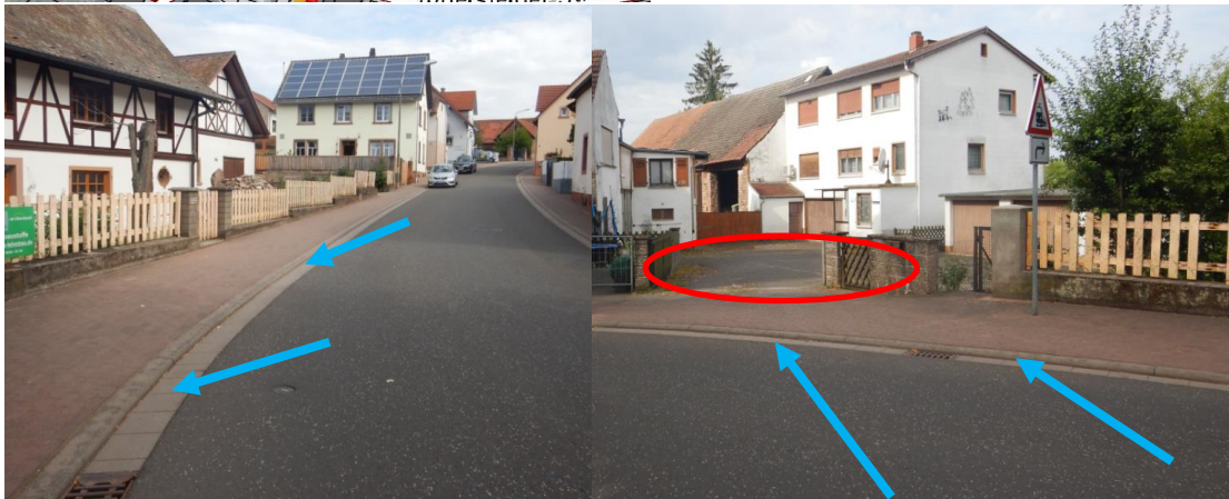
Abbildung 130: Überflutungsgefährdeter Bereich Imsbacher Straße (rot), Fließwege (blau)
