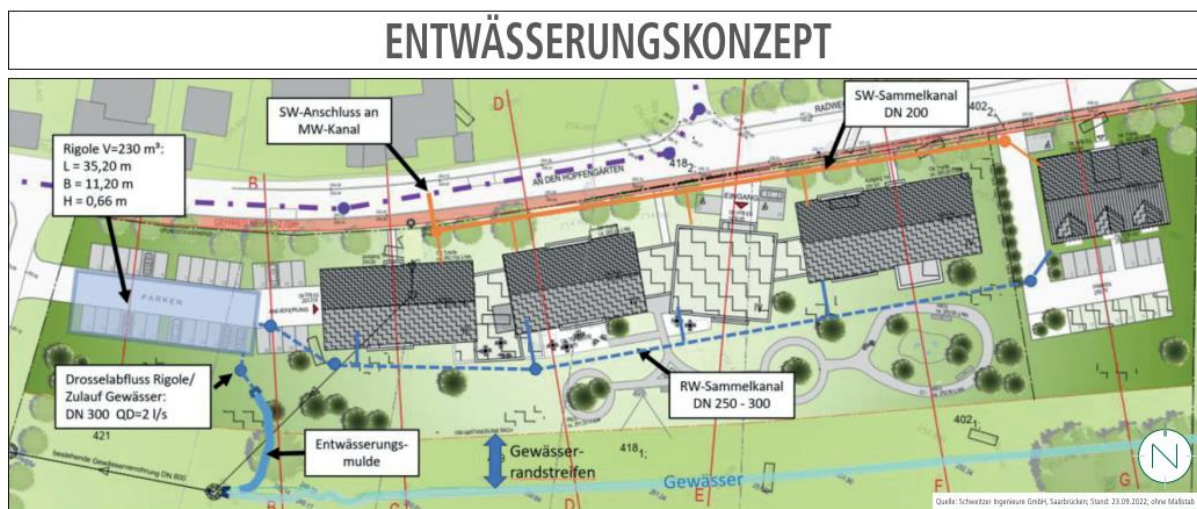
Abbildung 23: Entwässerungskonzept (Kern Plan, 12.10.2022)
