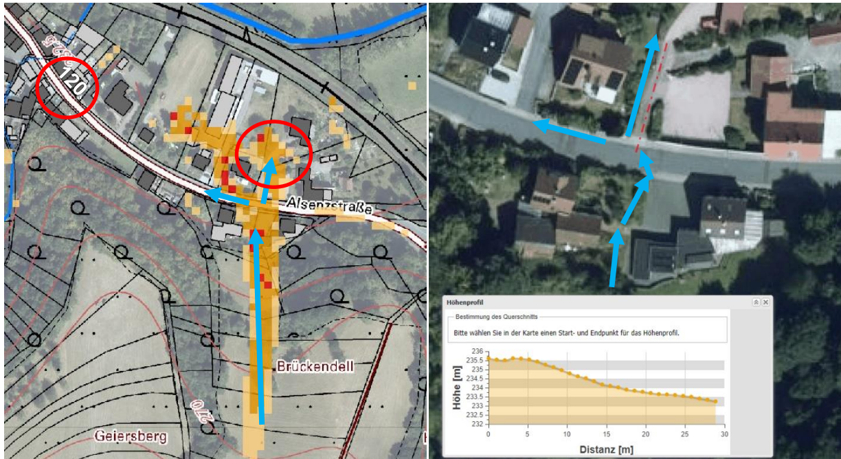
Abbildung 111: Brückendell, Fließwege (blau), potenziell überflutungsgefährdete Bereich (rot)
